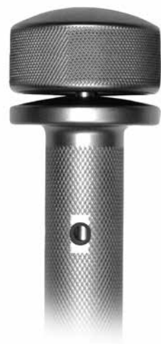
図14b インパクトプレートに完全装着していないストライクプレート
